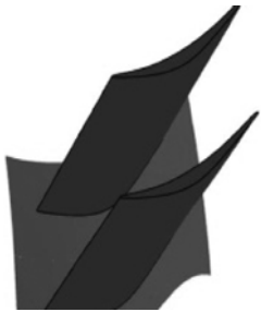
图 8 第一列静子叶片三维造型 Fig. 8 Three-dimensional geometry of the first stator
